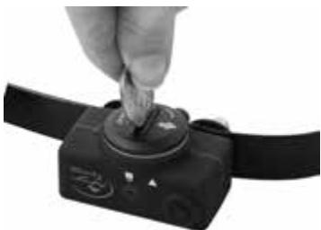
**UMETANJE BATERIJE:** Poravnajte simbole na bateriji (strelica), sa simbolom na uređaju (trokut). Iskoristite veću kovanicu kako bi okrenuli bateriju u smjeru kazaljke na satu dok se strelica ne poravna sa simbolom zaključavanja (lokot) na uređaju.
